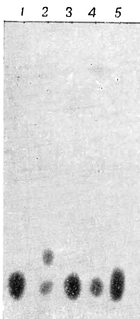
Р и с. 154. Хроматограмма солей этиламина. Система: уксусная кислота с 5% воды. Проявление пингидрином (Д 112). 1 — фосфат; 2 — пикрат; 3 — сульфат; 4 — йодистоводородная соль; 5 — солянокислая соль.
