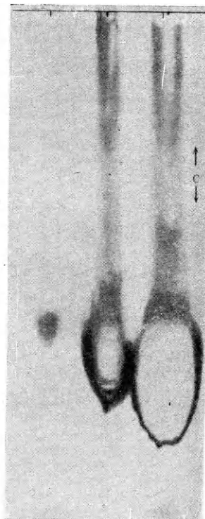
Р и с. 80. Хроматографическое поведение значительного количества малорастворимого вещества (Хайс). Система: n -бутанол—уксусная кислота—вода (4 : 1 : 5). Проявление нингидрином. На линию старта нанесены 12, 300 и 900 мкг тирозина.* Пятно тирозина для больших количеств имело бледную середину, сероватую полосу от линии старта и интенсивно фиолетовую кайму. В месте, обозначенном ← б →, оттенок слегка красноватый. Опрыскивание бромфеноловым синим показало, что кислота находится в области ← с → у всех трех образцов, а у образцов 300 и 900 мкг — от ← с → до фронта пятна занимает всю поверхность, дающую положительную реакцию с нингидрином.
